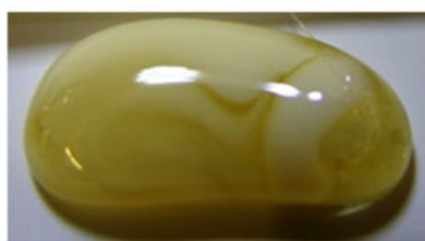
Ryc. 1b: Lakier jako zawiesina, z nierównomiernie rozprowadzonymi, nierozpuszczonymi związkami fluoru [4]
